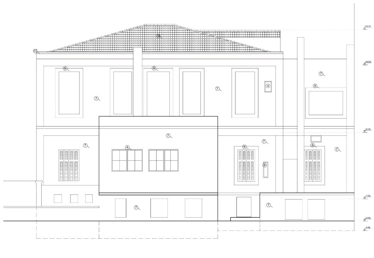
Εικ. 3.1.Η. Πίσω όψη υπάρχουσας κατάστασης διατηρητέου κτιρίου
